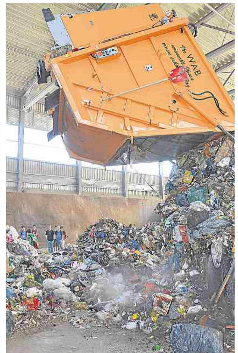
Auf der Mülldeponie in Meudt wird der im Westerwaldkreis gesammelte Hausmüll aus den Sammelfahrzeugen entladen und von dort in größeren Mengen zu Sortierungs- und Verwertungsanlagen gebracht.
